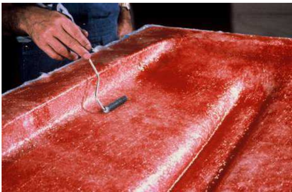
Composite fabriqué par moulage au contact (CARMA, 2006)
