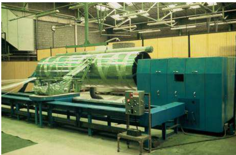
Procédé de l'enroulement filamentaire (CARMA, 2006)
